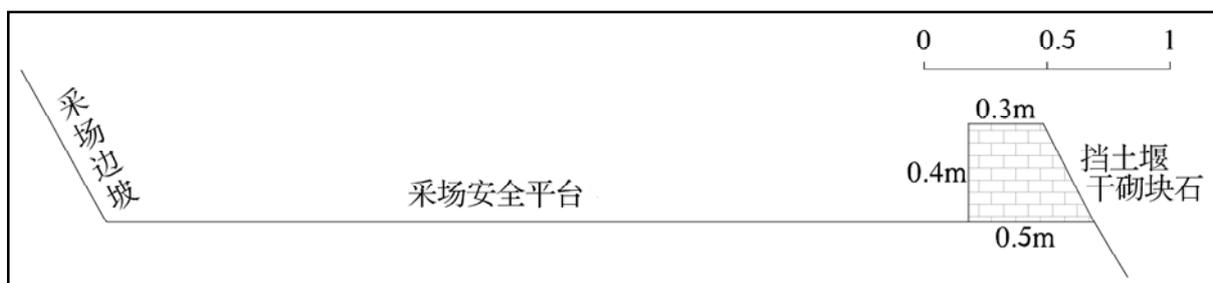
图 5-2 挡土堰设计图（单位 mm）
