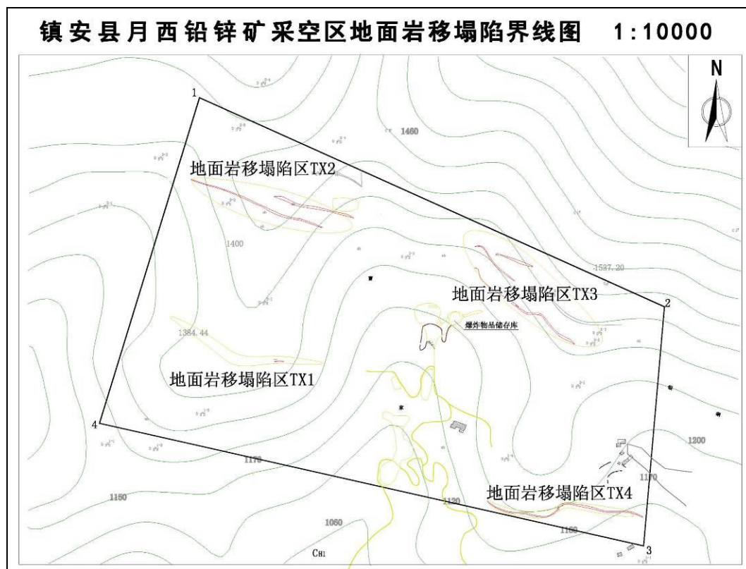
图3-4 预测采空区地面岩移塌陷界线图
