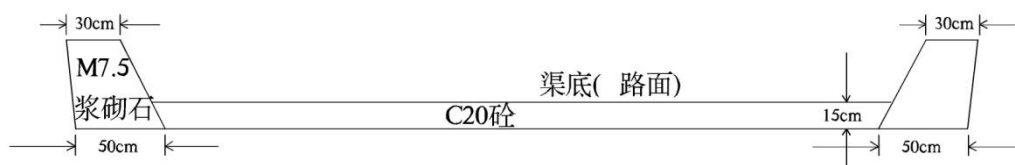
图 5-4 ZD1 下游沟谷排导渠大样图
