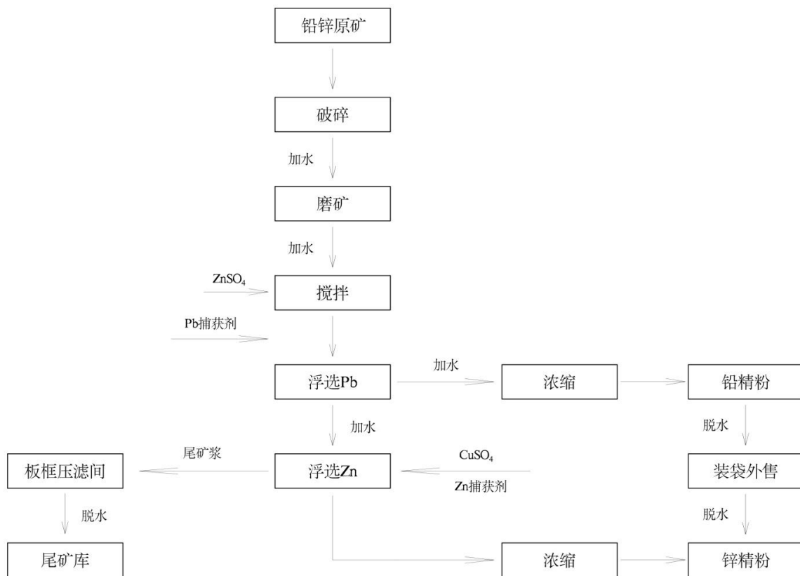
图 1-5 窑沟铅锌矿浮选工艺流程
