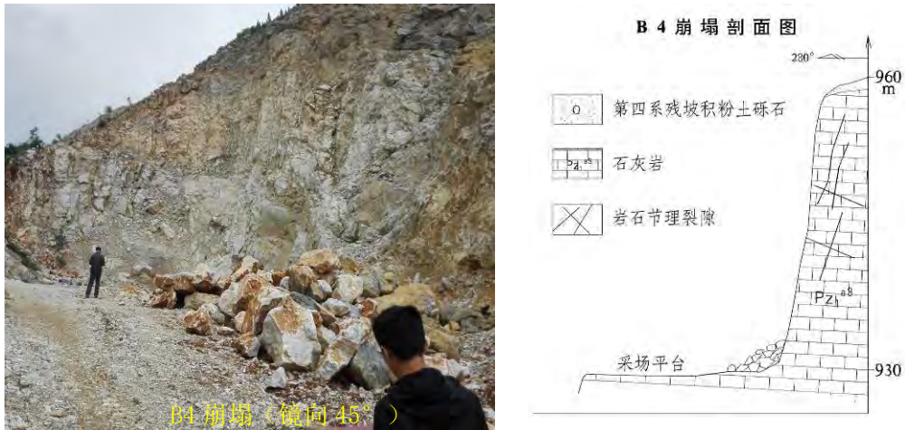
图 3-3 B4 崩塌隐患及剖面示意图
