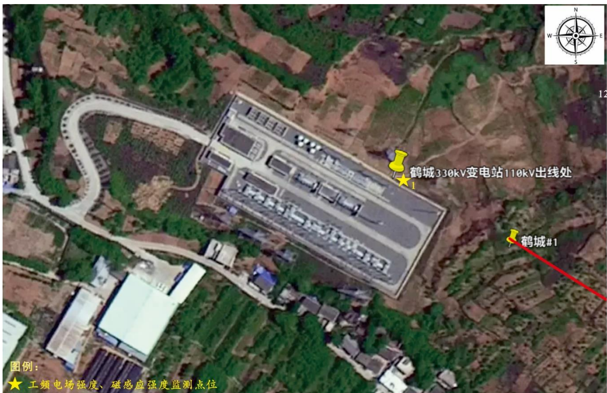
图1 鹤城330kV变电站电缆出线侧监测点位
