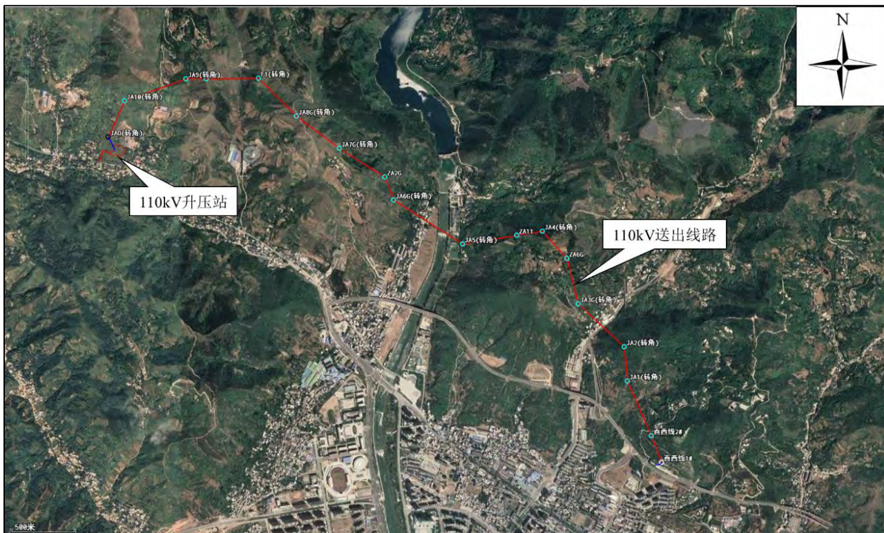
图1-2 110kV升压站与110kV送出线路概况
