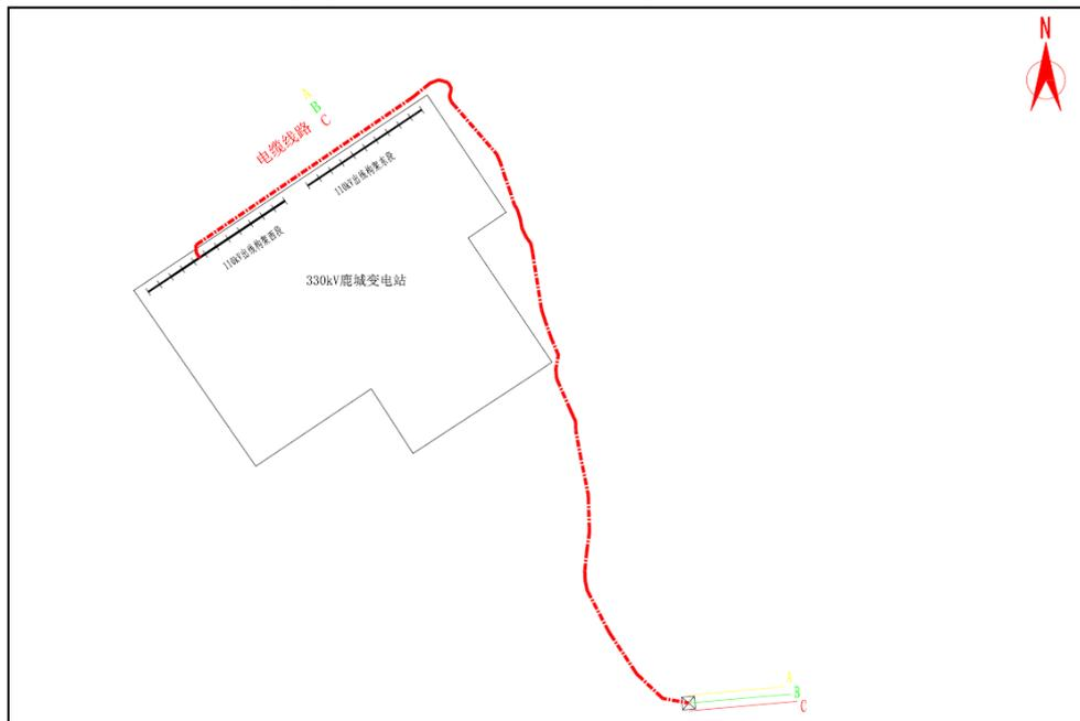
图6 项目接入330kV鹿城变电站进线示意图
