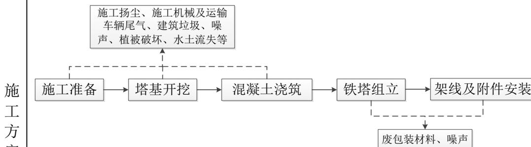
图8 架空线路工程施工工艺流程及产污环节图
