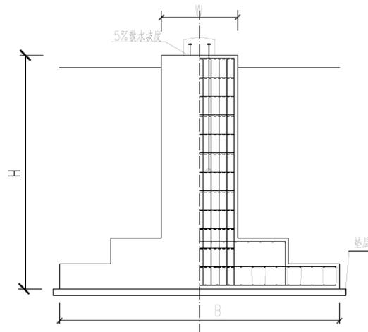
图9 板式直柱基础图
