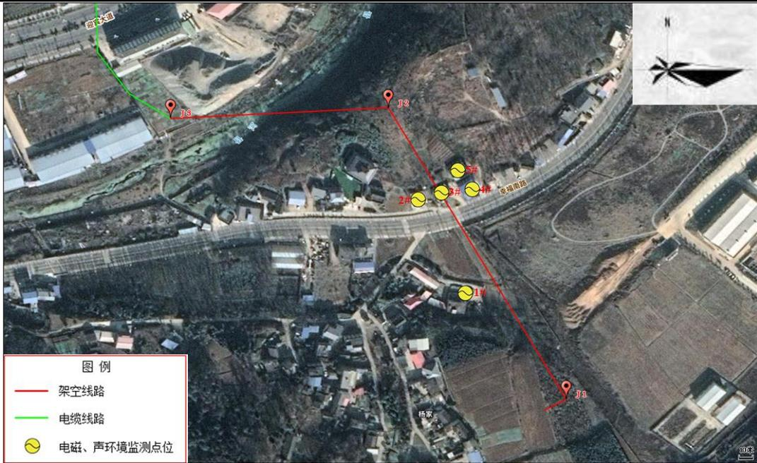
图 12 项目电磁、声环境现状监测点位示意图
