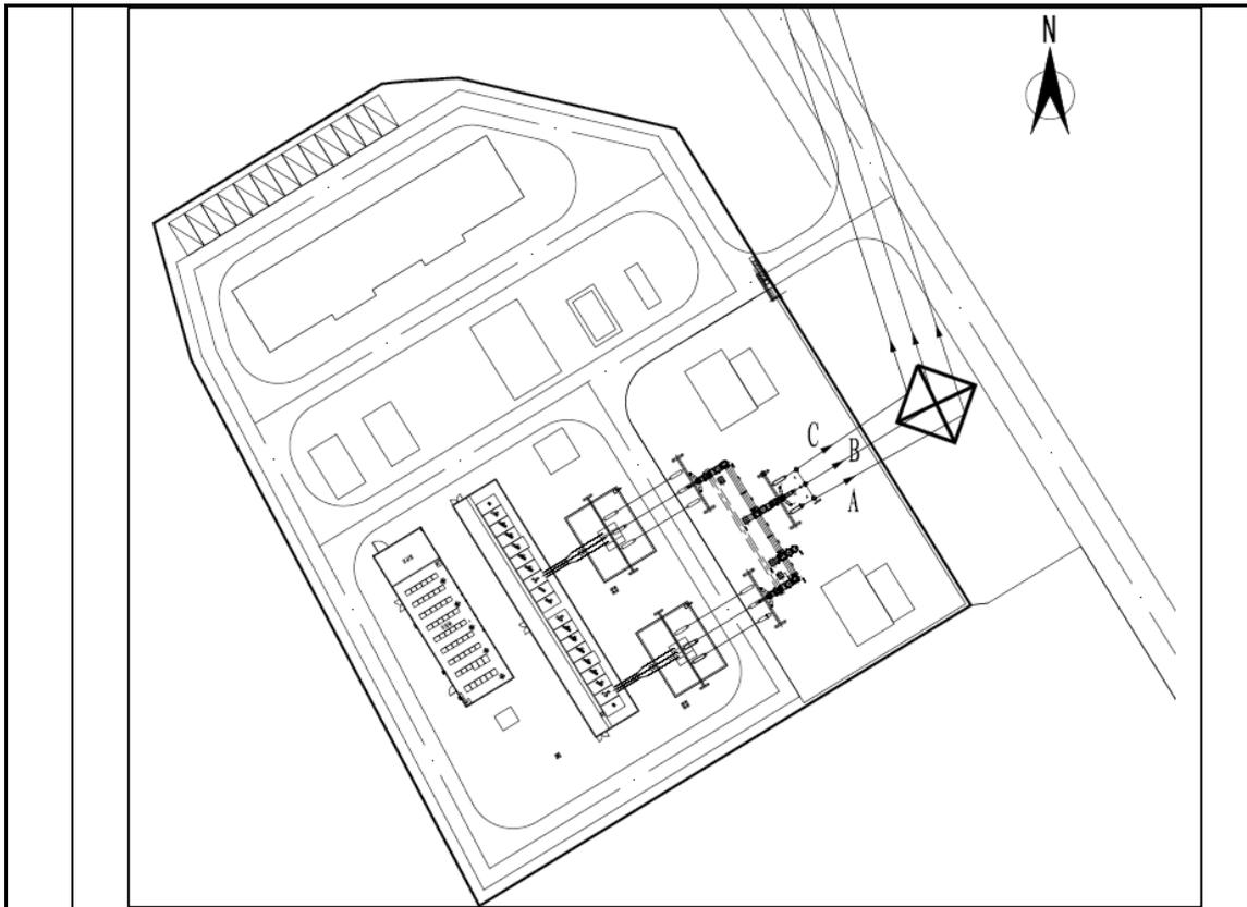
图5 项目光伏电站110kV升压站出线示意图
