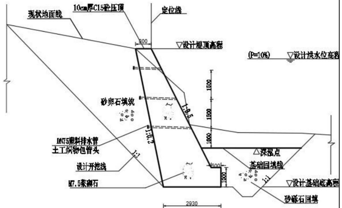
图 2-1 浆砌石仰斜式挡墙结构图
