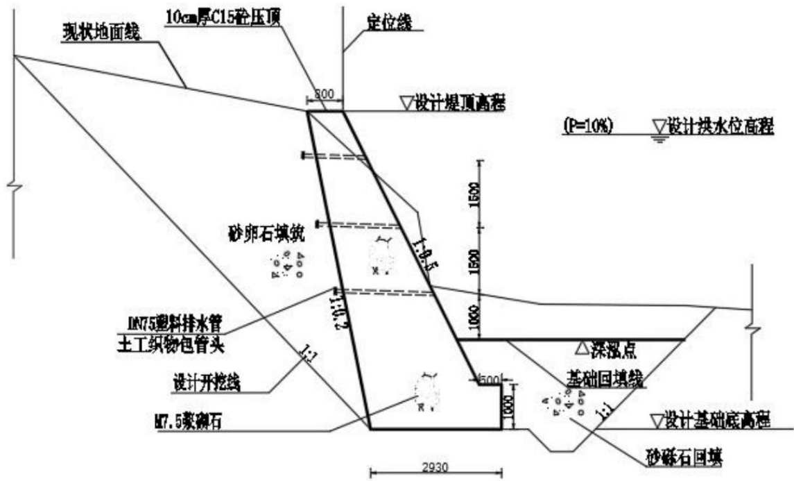
图 2-1 工程护岸横断面结构图
