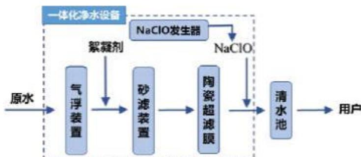
图 2.9 两岭水厂工艺流程图
